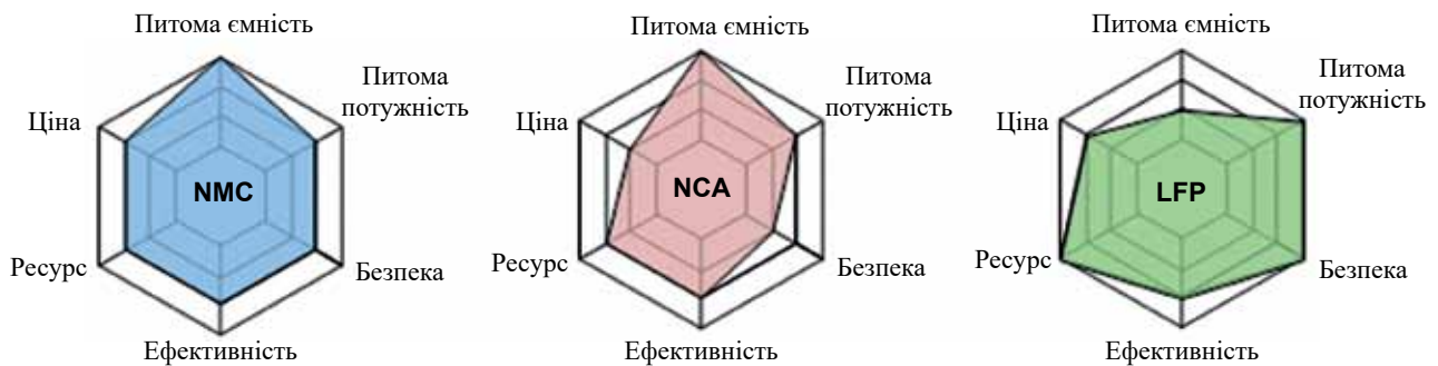
Рис. 3. Експлуатаційні характеристики акумуляторів з хімічними системами різних типів [5]
